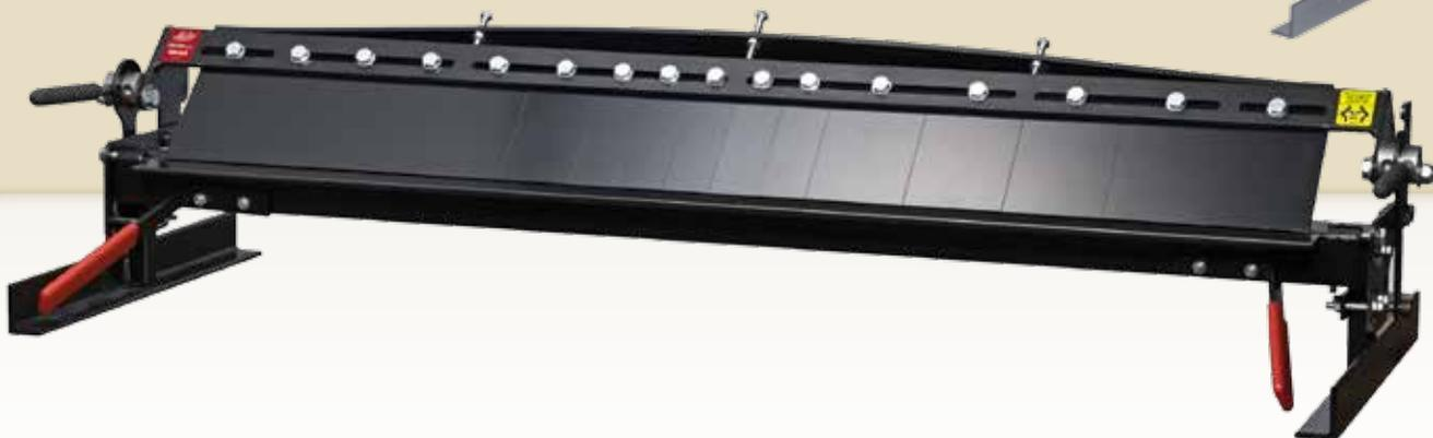
***Pour exécuter des cintrages de 135°*** dans l'acier galvanisé de calibre 22 (0,86 mm) jusqu'à 1,20 m (48 po) de large.
