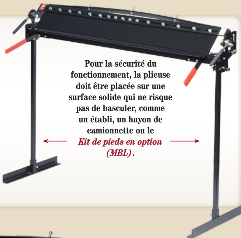
Pour la sécurité du fonctionnement, la plieuse doit être placée sur une surface solide qui ne risque pas de basculer, comme un établi, un hayon de camionnette ou le *Kit de pieds en option (MBL)*.
