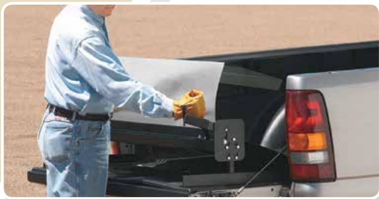
Permet d'exécuter des cintrages à 135 degrés dans l'acier galvanisé jusqu'à un calibre 22 (0,86 mm). Un tablier renforcé en acier plaqué de 7,9 mm (5/16 po) et une capacité de largeur de 1,20 m (48 po) font de la Mini-Brake l'outil idéal pour la confection de plénums ou de raccords de grande taille sur le chantier.
